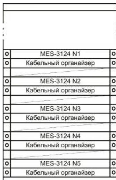
Рисунок 9 – Размещение коммутаторов MES-3124 в стойке
