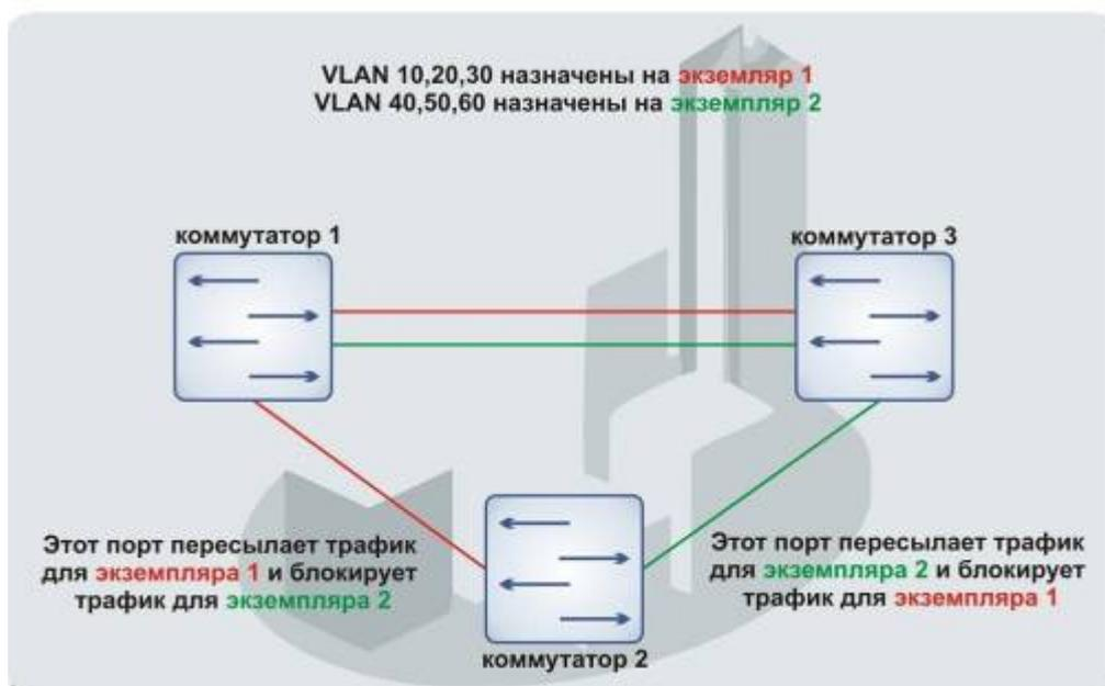
Рисунок 10- Настройка протокола множества связующих деревьев
